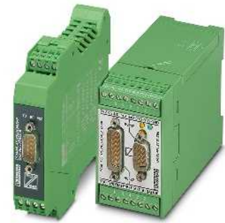
Преобразователь RS-232 для RS-485 и RS-422
