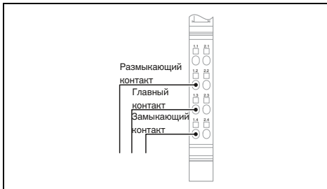
1 / 4 релейных выходов, 5-253 В перем. тона, контакты с золотым покрытием
