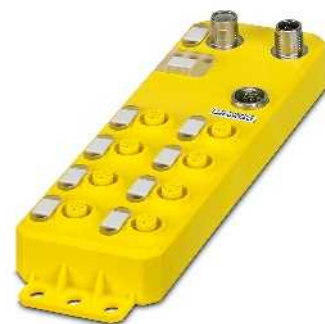
8 цифровых входа и 8 цифровых выходов
