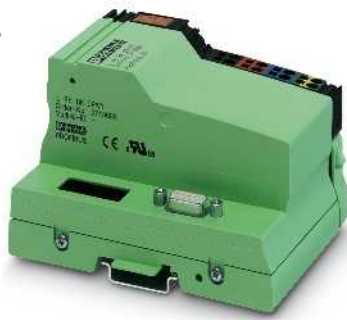
Устройство сопряжения с шиной PROFIBUS, разъем
