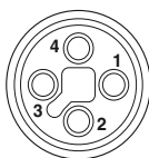
Расположение контактов гнезда M12, 4-конт., с мех. ключом T, вид со стороны гнезда
