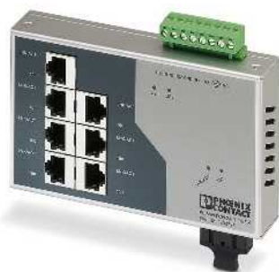
7 / 15 портов RJ45 и 1 оптический порт
