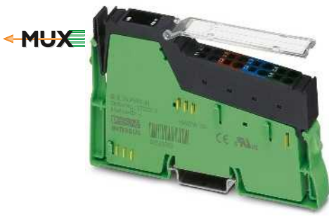
Питание 24 В пост. тока U_M и U_S , с предохранителем и диагностическим индикатором
